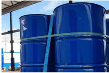
Variante 5a: Spanngurt **hinter** dem Strap /
