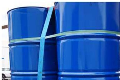
Variante 5b: Spanngurtverlauf **über** den Strap /
